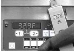
Se le due temperature differiscono di meno di 3°C (in più o in meno), non è necessario regolare l'impostazione della temperatura.
