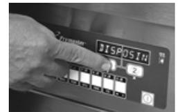
**Assicurarsi che l'unità MSDU (McDonald's Shortening Disposal Unit o carrello per la rimozione dell'olio) sia correttamente posizionata sotto il beccuccio di scarico della friggitrice.**
