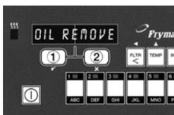
**Vasche intere:** Il computer visualizza IS OIL REMOVED? (Olio rimosso?) che si alterna con YES NO (Sì No).
